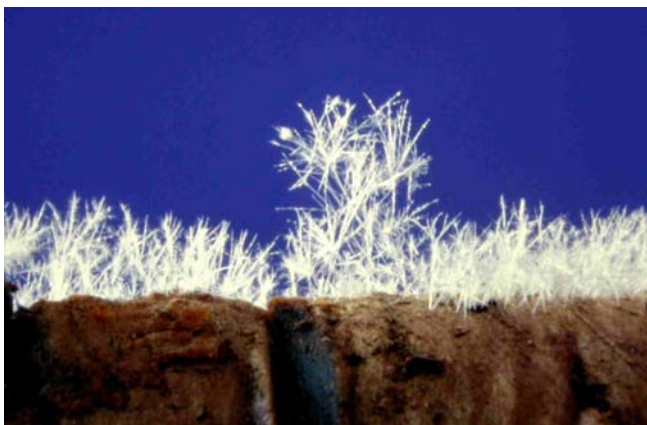
Abbildung 2: Aus Birkenkork unter Hitzeeinwirkung sublimiertes Betulin (Foto A. Scheffler).
